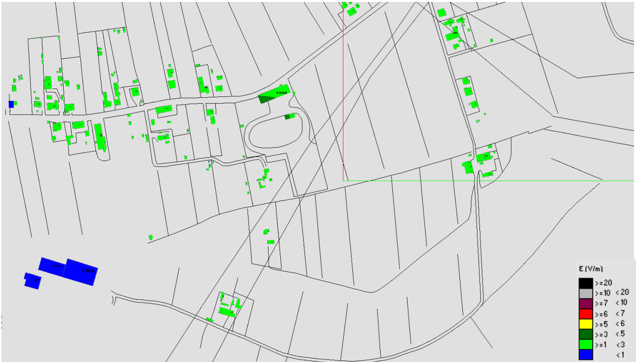
Fig. 24 Impatto elettromagnetico – zona Via dei Tavi e Centrale Enel – Ipotesi 2 – Vista dall'alto
