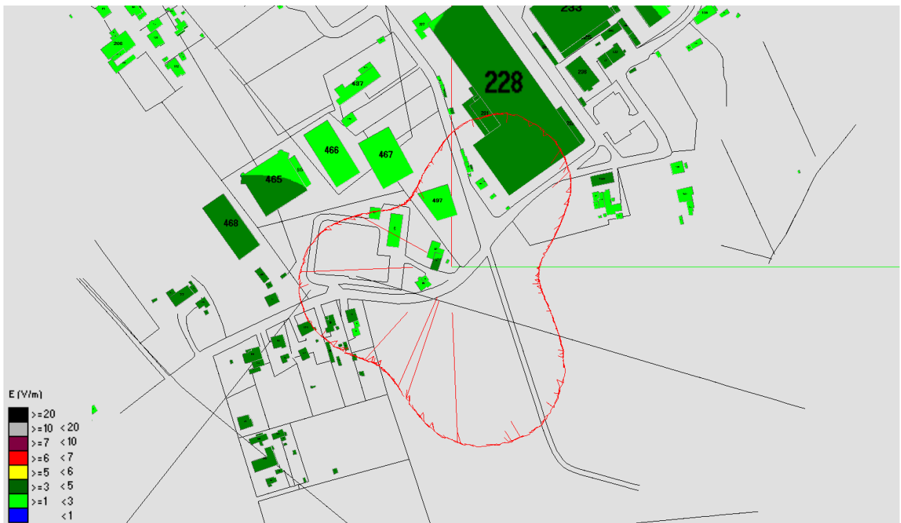
Fig. 33 Impatto elettromagnetico – Zona Via dei Tavi Centrale ENEL – Vista dall'alto
