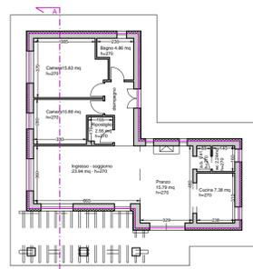
PIANTA PIANO TERRENO in scala 1:200
