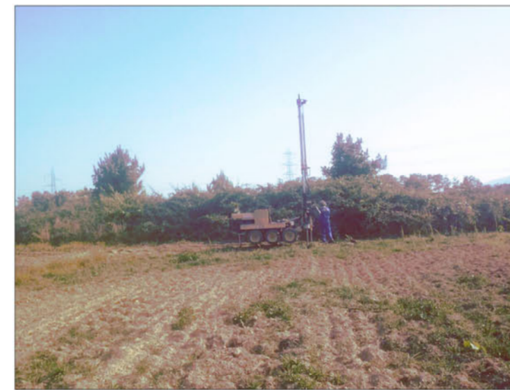
F.3 - Penetrometria statica CPT3 effettuata nell'ambito della presente indagine.
